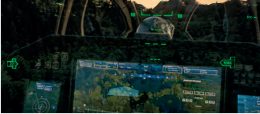
Realidad aumentada del Bell 360 Invictus, en donde se puede observar la cabina translúcida que presenta en este modo, aumentando la SA. (Imagen obtenida de un video público de Bell Helicopters. Copyright Bell Helicopters)
