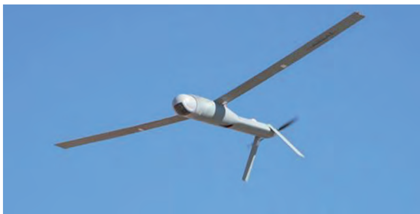
El Dron ALE ALTIUS en vuelo, en donde se puede observar la torreta FLIR en el morro. (Imagen: Area-I)
