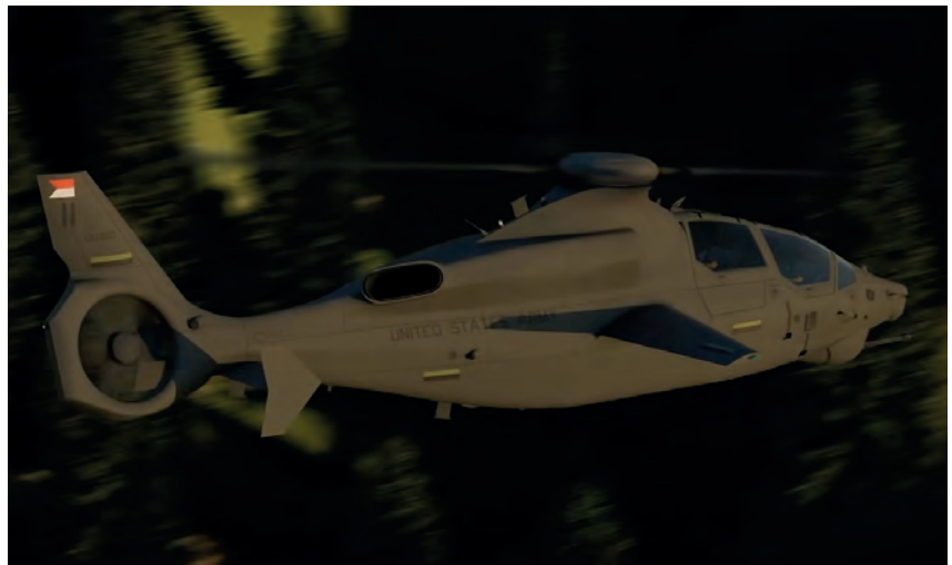
Bell 360 Invictus. En la imagen puede apreciarse la morfología de la tobera de escape (Imagen obtenida de un video público de Bell Helicopters. Copyright Bell Helicopters)
