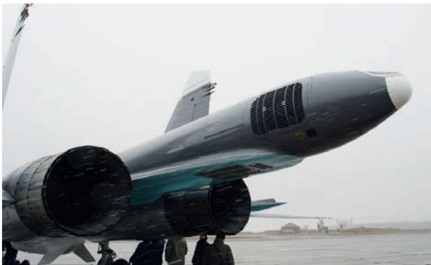
Detalle del agujón de cola, junto con los lanzadores de chaff/flare situados en la zona ventral. (Imagen: Dmitri Chushkin)
