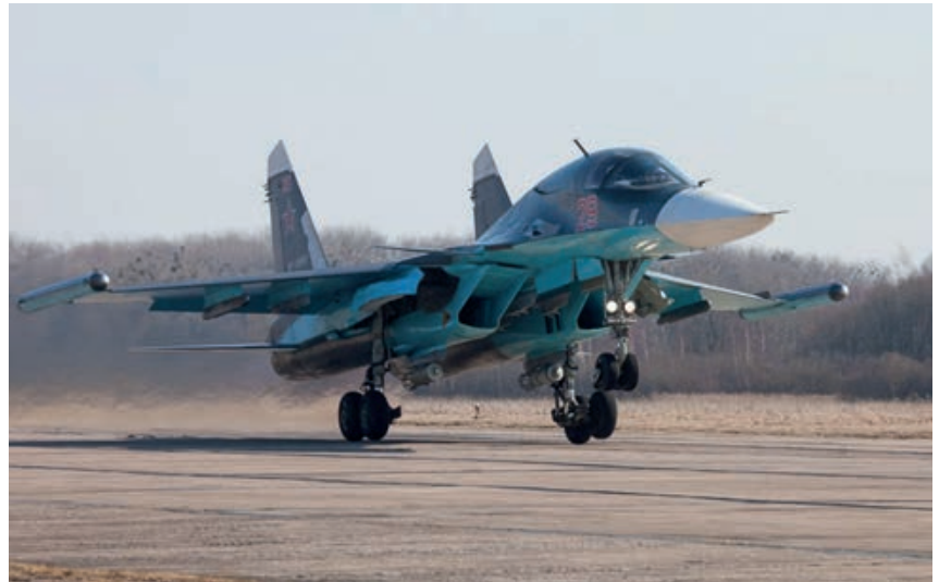
Su-34 Fullback con pods KNIRTI L265V montados en un Su-34 tomando tras realizar una misión en Siria (Russian Ministry of Defense)
