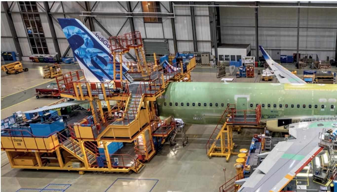
*El prototipo A321XLR en la línea de montaje final de Hamburgo. (Imagen: Airbus)*
