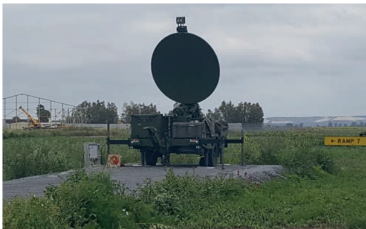
Antena WBDL, segmento terrestre. Capacidad desplegable
