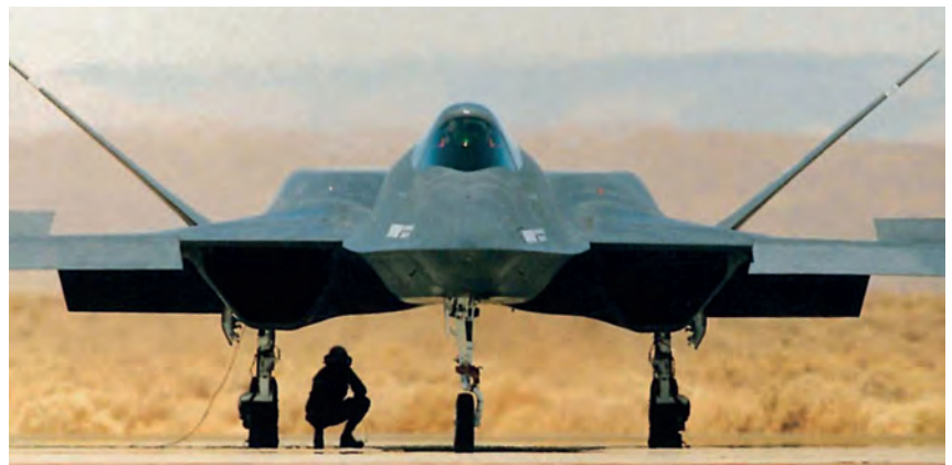
El YF-23 durante una pre vuelo. Se puede observar también la morfología del chine. (Imagen: Northrop Grumman - USAF)
