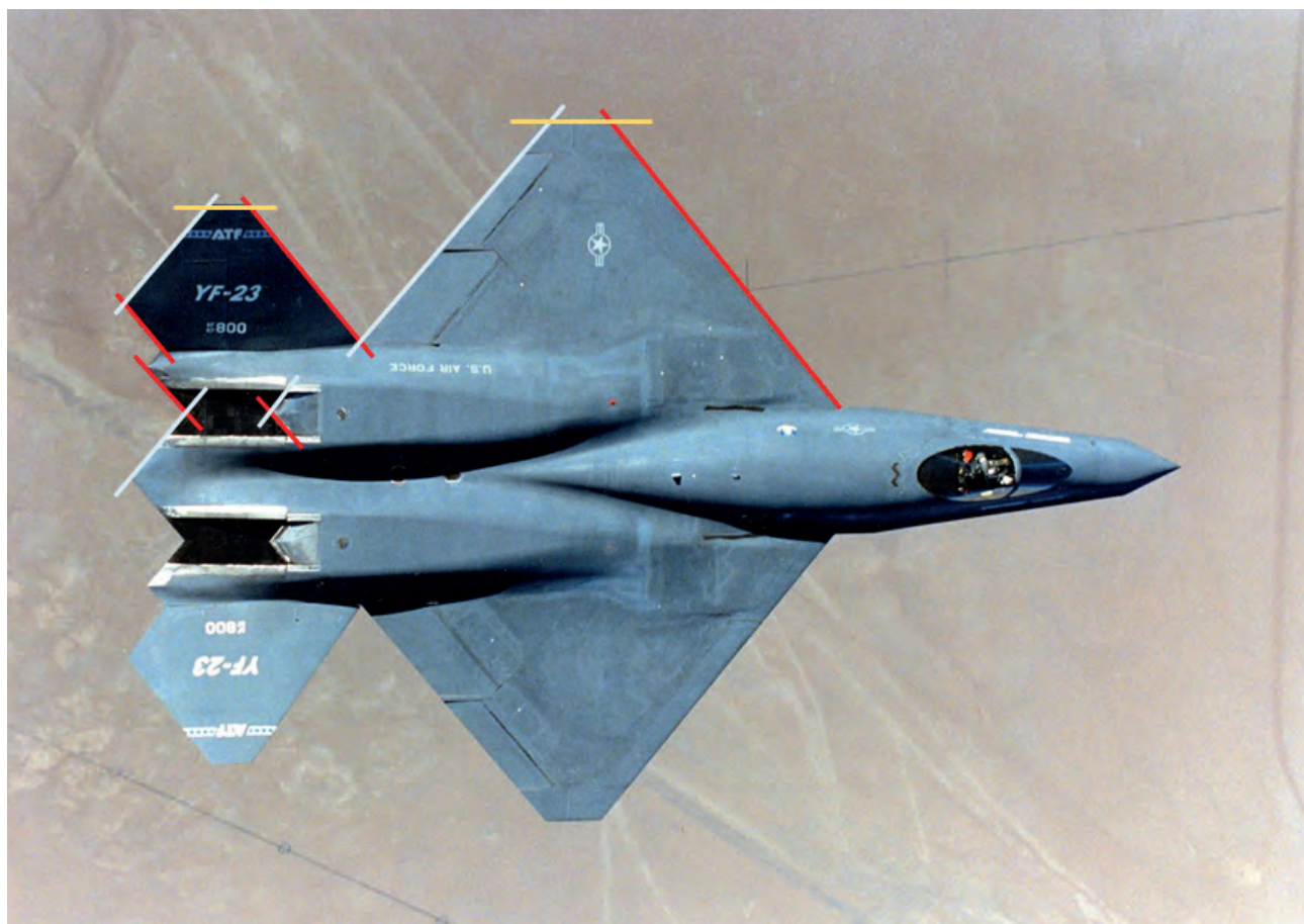
YF-23 PAV-1 en donde se puede apreciar la configuración angular base según el principio «planform alignment» (señaladas en el lado izquierdo únicamente). (Imagen del autor sobre el original de Northrop-Grumman - USAF)
