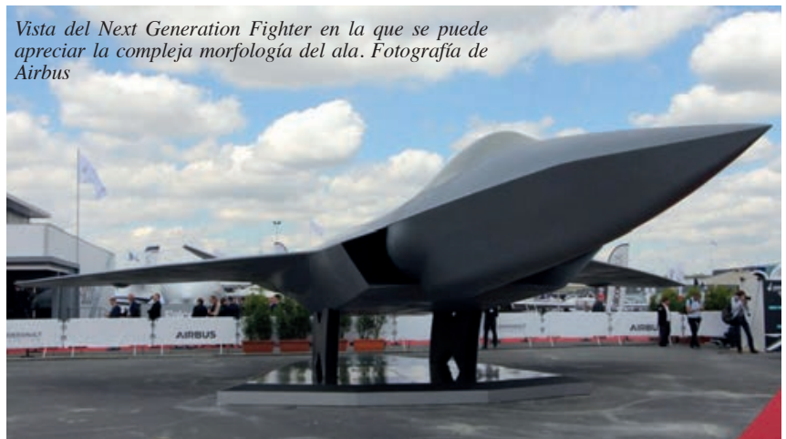
Concepto NGF y el remote carrier . Se aprecia el diseño del NGF basado en el concepto planform alignment en cuanto a simetrías y paralelismos de los diferentes planos. Imagen tomada de un video público de Sam Chui
