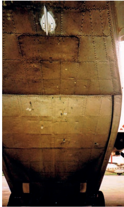
Impactos de metralla en la rampa
