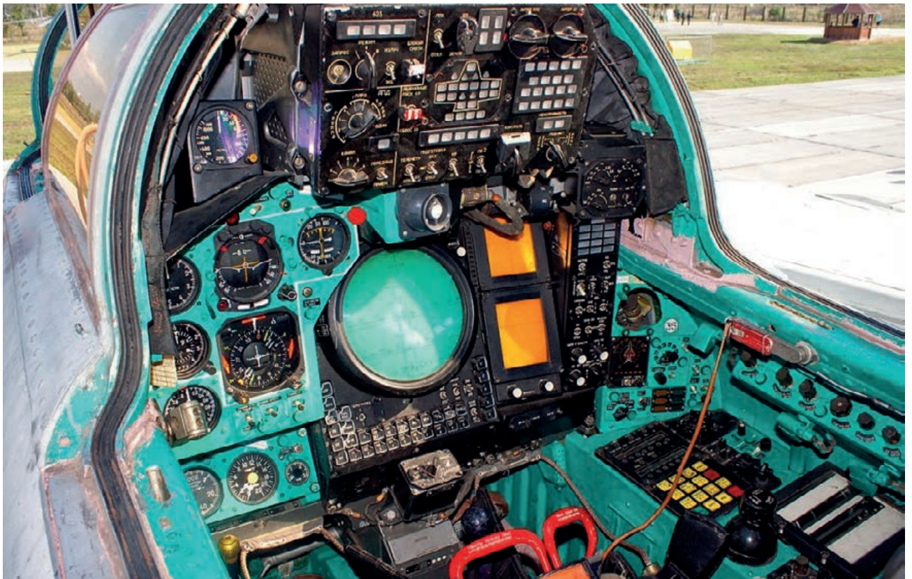
Cockpits delantero y trasero del MiG-31 originales. Cabe destacar la fuerte presencia de instrumentación analógica, claramente superada hoy en día. (Imagen: Vitaly V. Kuzmin)
