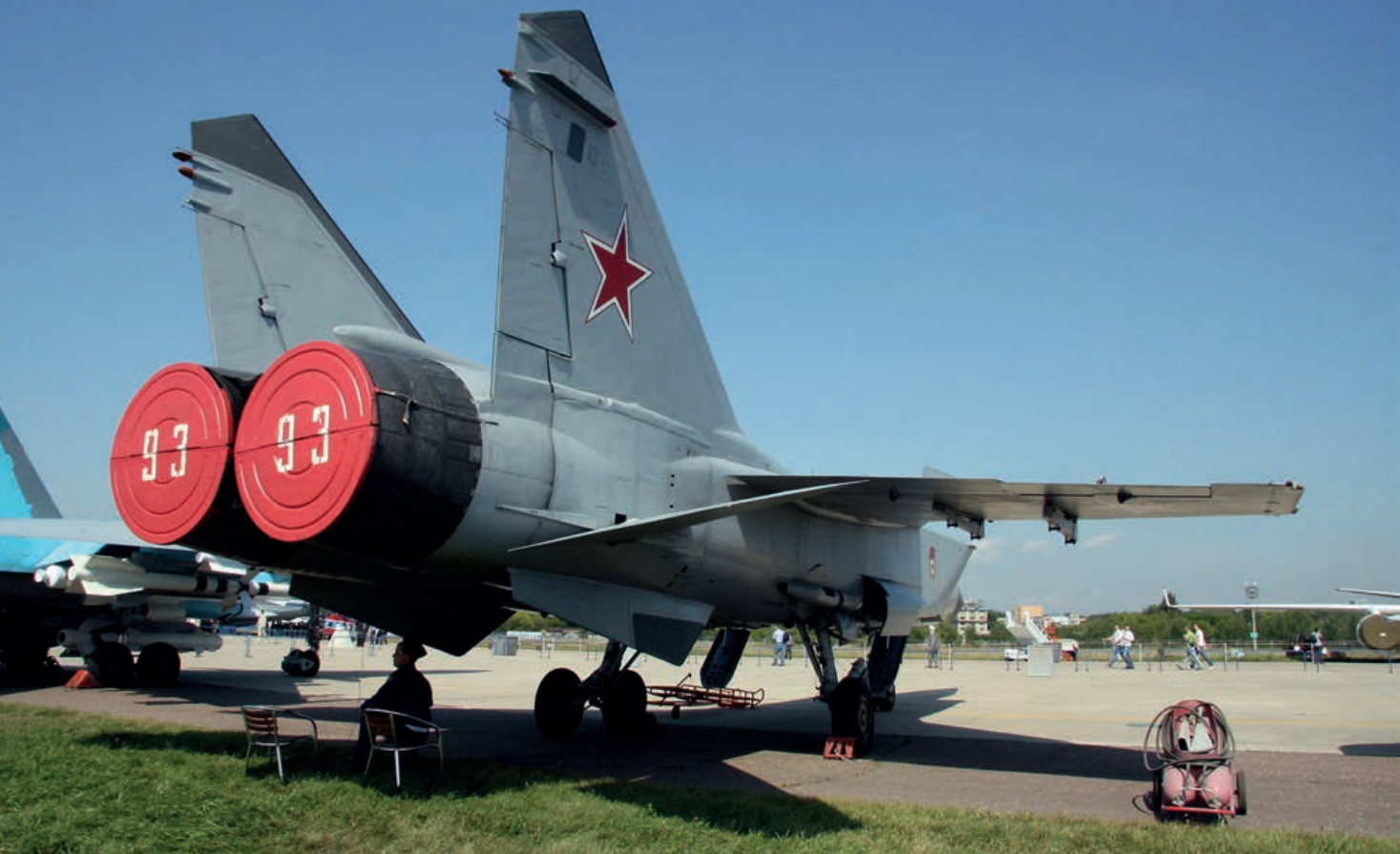
MiG-31, exposición estática en el MAKS 2009. Se puede apreciar tanto el generoso tamaño de las toberas como los receptores del sistema de guerra electrónica, así como el ángulo de las derivas verticales (Imagen: Vitaly V. Kuzmin)
