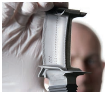
Figura X3. Orificios para refrigeración y recubrimientos térmicos en un moderno ábalo de turbina
