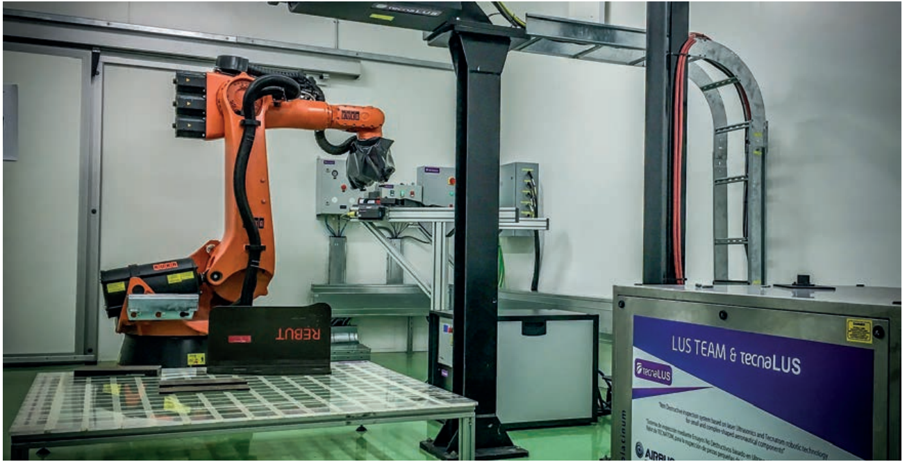
Sistema de inspección aeronáutico TecnaLUS basado en las tecnologías RABIT y ultrasonidos generados por láser
