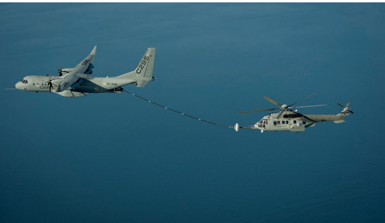
C-295W, una innovación en reabastecimiento en vuelo realizada por Airbus con un helicóptero H225M Caracal
