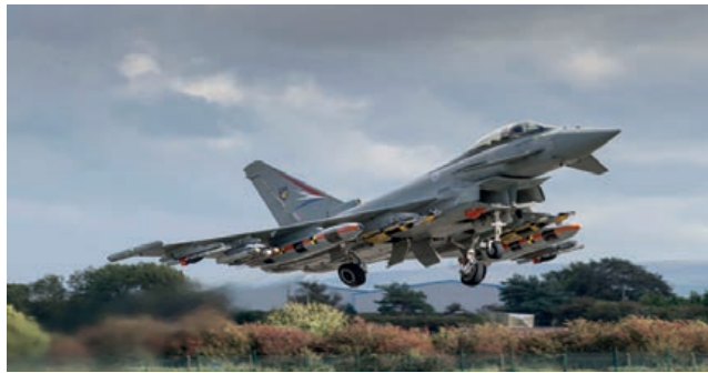
Despegue del avión instrumentado IPA6 para pruebas del misil Brimstone. (Imagen: BAEs)
