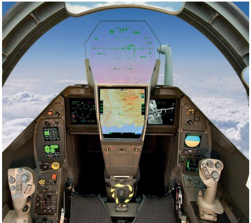
de sensores y sistemas de los que está dotado el avión. Esta información, se complementa con la mostrada al piloto en su línea visual frontal a través del HUD de gran angular. La información mostrada depende de la configuración que decida el piloto, tanto a través de los menús de configuración de las propias pantallas como a través del HOTAS (Hands On Throttle And Stick, denominado en Francia 3M –Main sur Manche et Manette).
