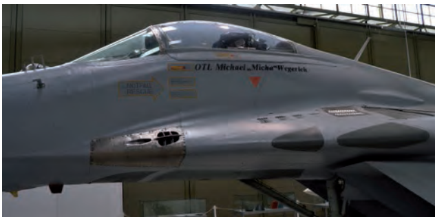
Vista de costado del MiG-29G del Museo de la Luftwaffe de Gatow. Apreciamos los detalles referidos a la boca del cañón interno con su rejilla de ventilación. Sobre el ala las cuatro rejillas para la toma de aire una vez se cierran las tomas principales (foto P. Redón).
