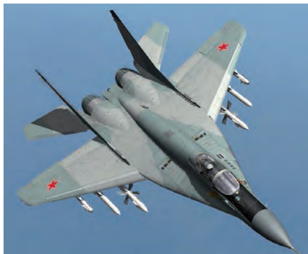
Esta vista del dorso de un MiG-29A "Fulcrum-A" soviético nos permite observar su geometría, las tomas de aire auxiliares y los seis misiles con que va armado. Frente a la cabina y ligeramente descentrado vemos el sensor de infrarrojos (foto colección Mijail Kozlov).
