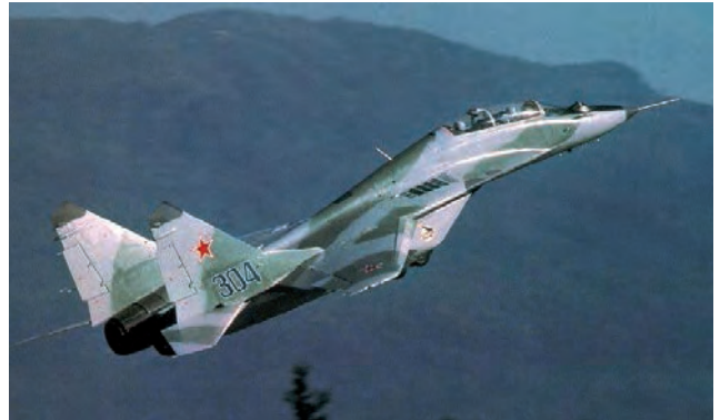
Este es uno de los primeros biplazas de la era soviética. Carecía de radar (foto colección Mijail Kozlov).
