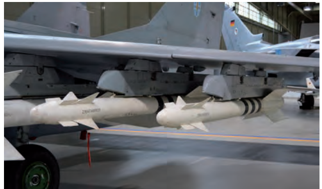
Dos de los cuatro misiles aire-aire Vympel R-73 (AA-8 "Aphid") que emplean los MiG-29 (foto P. Redón).
