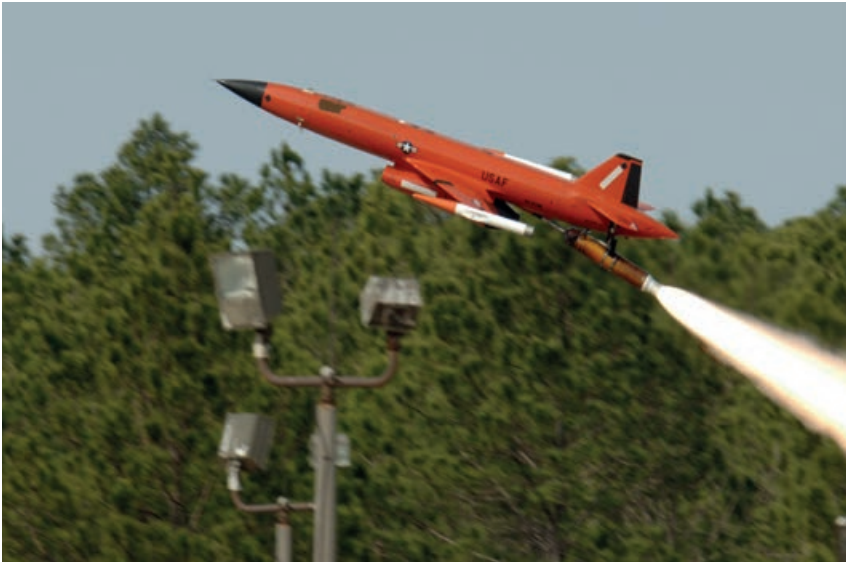
El lanzamiento del UTAP-22 se realiza por medio de un motor cohete para luego ser propulsado por un motor turbojet.
