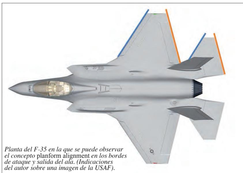
Planta del F-35 en la que se puede observar el concepto planform alignment en los bordes de ataque y salida del ala. (Indicaciones del autor sobre una imagen de la USAF).
