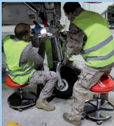
Personal de mantenimiento trabajando en la primera de las inspecciones de 100 Hv de avión que se realizó en el Destacamento.
