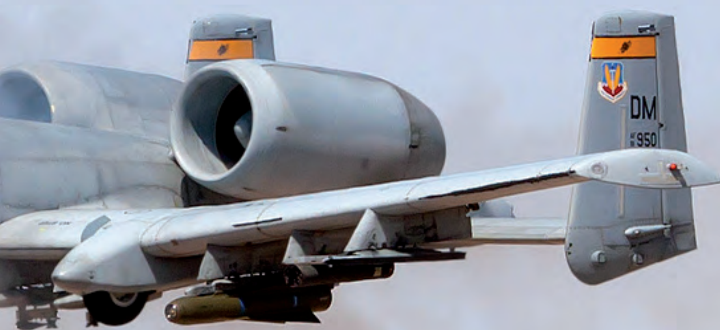
EL A-10 DISPARANDO UNA RÁFAGA CON SU CARACTERÍSTICO CAÑÓN, EL GAU-8 "AVENGER".
