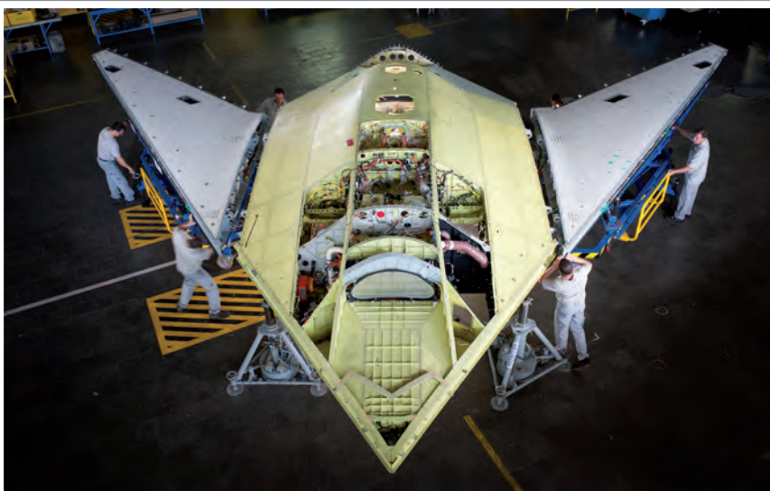
Ensamblaje final de Neuron, por el equipo de Dassault Aviation en Istres. (Foto Dassault Aviation/S. Randé).
