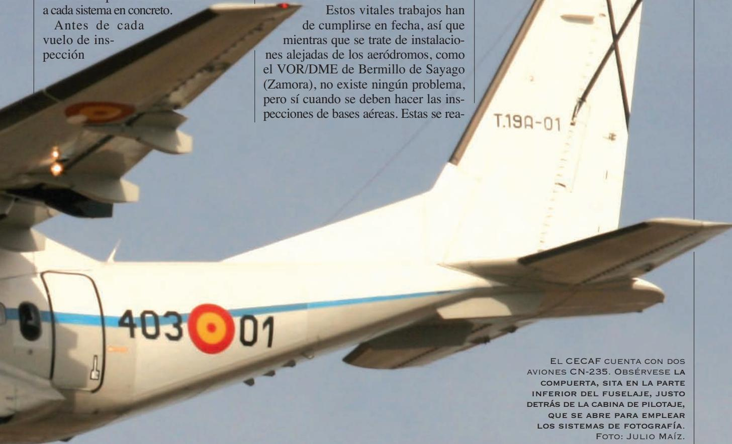
EL CECAF CUENTA CON DOS AVIONES CN-235. OBSÉRVESE LA COMPUERTA, SITA EN LA PARTE INFERIOR DEL FUSELAJE, JUSTO DETRÁS DE LA CABINA DE PILOTAJE, QUE SE ABRE PARA EMPLEAR LOS SISTEMAS DE FOTOGRAFÍA. FOTO: JULIO MAÍZ.
