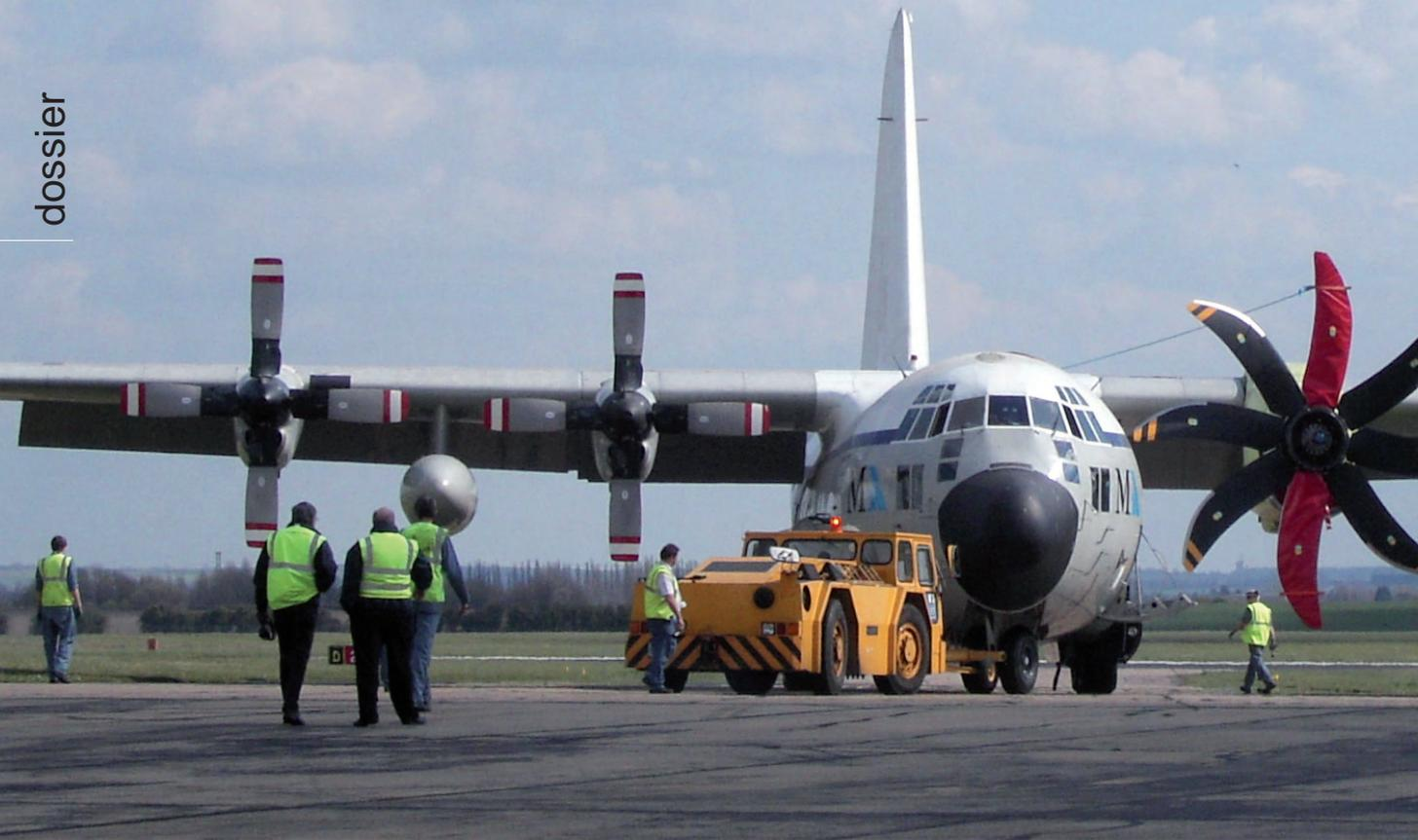
Motor TP-400-D6 montado en el C-130 de Marshall Aerospace
