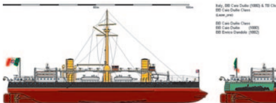
Dibujo del acorazado Caio Duilio . Se puede ver el dique que albergaba al torpedero Clio . (Foto Lazer-one)
