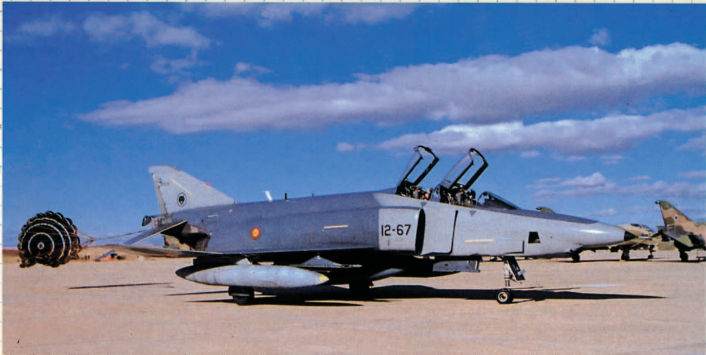
El paracaídas proporciona una frenada más eficaz. Además, podría llegar a usar el gancho, si fuere necesario, que junto con el EF-18, es la única plataforma del Ejército del Aire con esta opción de frenada.
