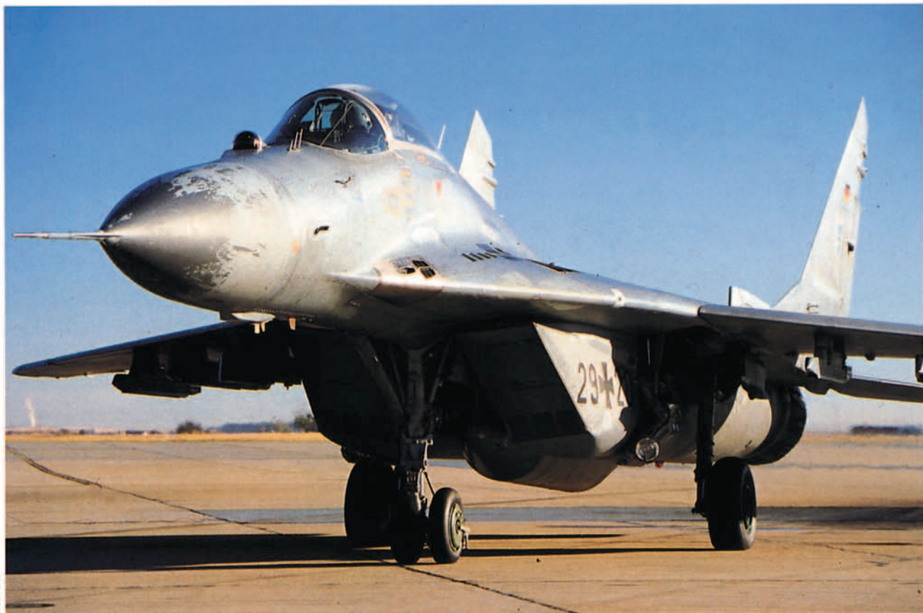
Desde este punto de vista se observan tres peculiaridades del Mig-29: Su sensor infrarrojo delante de la cabina, su depósito central conformado entre los motores, y sus compuertas de cierre de las toberas de admisión durante el rodaje.
