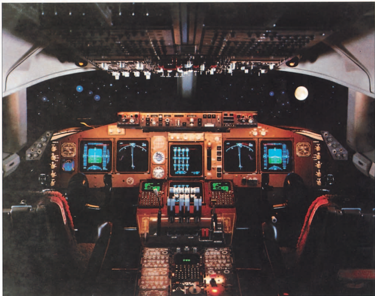
Cabina de pilotaje digital del 747-400.
