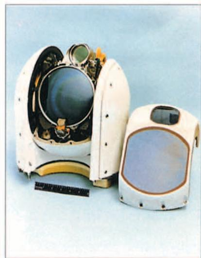
Fig. 4. Estabilizador óptico con transeptor láser incorporado.
