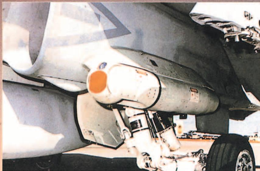
Fig.1. Pod FLIR/LTDR instalado en un F/A-18. Destacan la ventana para infrarrojo y la de emisión láser.
