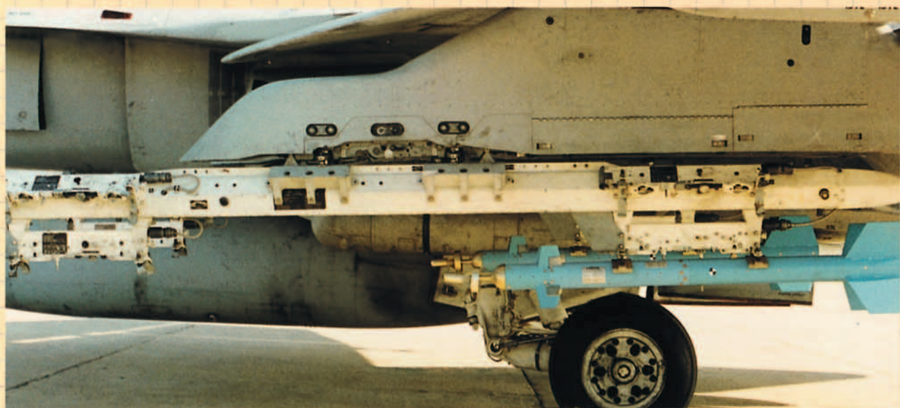
Bombas de prácticas láser (LGTR) validadas para su utilización en C.15.
