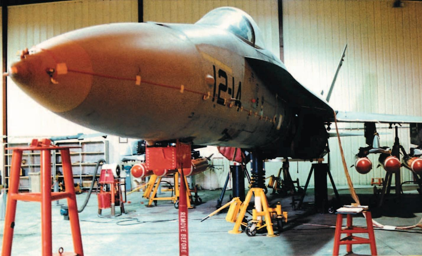
Avión C15-56 instrumentado sometido a ensayo de vibración en tierra con configuración crítica para flameo.
