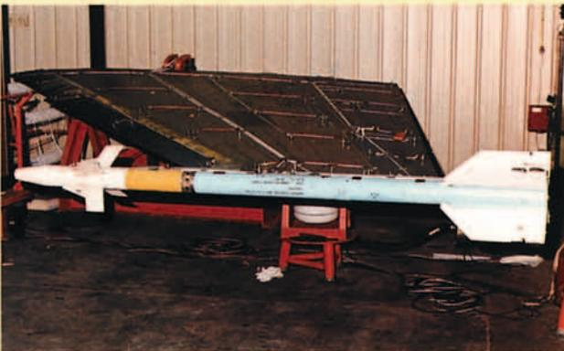
Ensayo de vibración en tierra de plano de avión Mirage F-1 para elaboración modelo teórico de flameo.
