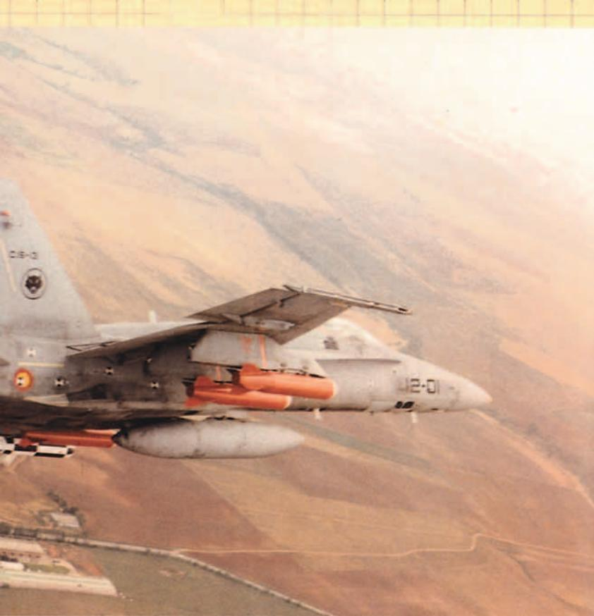
*Ensayo en vuelo de flameo con bombas BME 330 en EF-18*
