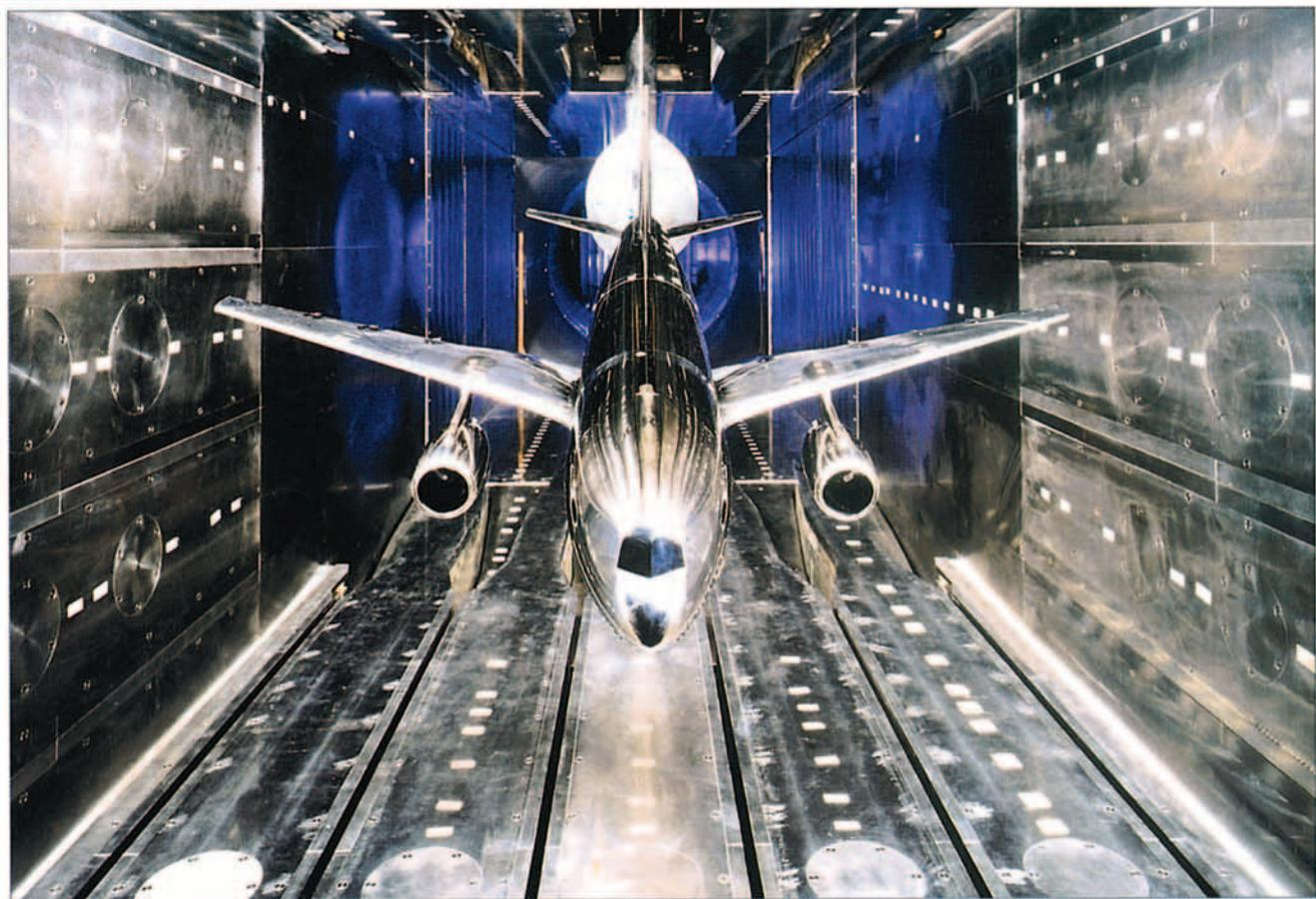
Figura 10. Maqueta-modelo en la cámara de ensayos del túnel aerodinámico criogénico ETW (European Transonic Windtunnel), inaugurado el 8 de junio de 1993, ubicado en Portz en las inmediaciones del aeropuerto de Colonia-Bonn. La sección transversal de la cámara de ensayos tiene unas dimensiones de 2'4 m x 2'0 m. y una longitud de 9 m.; pueden hacerse pruebas a temperaturas entre 40°C y -183°C a números de Mach de 0'5 a 1'3. Foto ETW: Atelier Schaler (Peter/Steinhausen/Pick).
