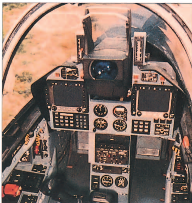
Dos conceptos (convencional y avanzado) de cabina en un mismo avión, "Alpha Jet".
