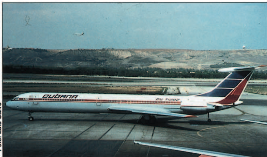
Fig. 10. Cubana, tiene todas sus flotas de aviones, fabricados por la antigua URSS. En la fotografía, captada en el aeropuerto de Madrid-Barajas, un Ilyushin 62M, avión de cuatro motores "turbofan" Soloviev. 12 aviones de este tipo, componen la flota con la que Cubana realiza los vuelos de gran radio de acción.
