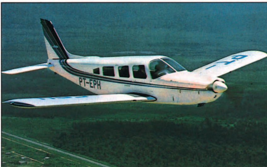
Fig. 16. La aviación general en Iberoamérica, tiene una amplia gama de aviones fabricados por Embraer de Brasil. En la fotografía, un EMB-721 C "Sertanejo", propulsado por un motor Lycoming de inyección, de 300 HP, que proporciona al avión velocidades de crucero hasta de 210 km/h; dispone de avanzado instrumental electrónico para navegación y radiocomunicaciones, piloto automático, e instrumentación que le permite volar en condiciones IFR.
