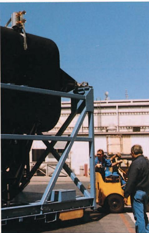
Módulo de propulsión fabricado por McDonnell Douglas, que será utilizado para el ajuste orbital y de actitud de los grandes conjuntos que serán lanzados al Espacio para la instalación de la Estación Espacial Internacional de la NASA. Foto McDonnell Douglas.
