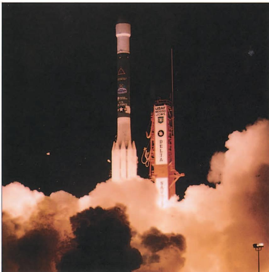
*El lanzador Delta II fabricado por McDonnell Douglas como subcontratista principal, que ha sido bautizado como el DC-3 del Espacio, por su alta versatilidad de utilización. Con el Delta II se están lanzando los satélites NAVSTAR para el GPS (Global Positioning System) sistema de Navegación vía satélite que estará completamente operativo a partir del otoño de este año 1993. En los últimos 14 años los lanzadores Delta han mantenido una fiabilidad operativa del 98'6%.*
