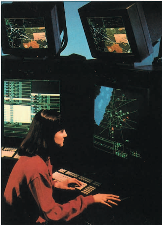
Fig. 5. Los datos de posición ADS son procesados y presentados en el centro de control de tránsito aéreo
