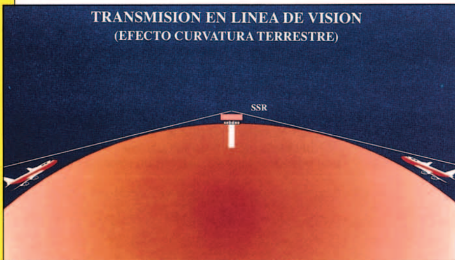
Fig. 3. La curvatura de la tierra limita el alcance del radar al quedar las aeronaves por debajo del horizonte.
