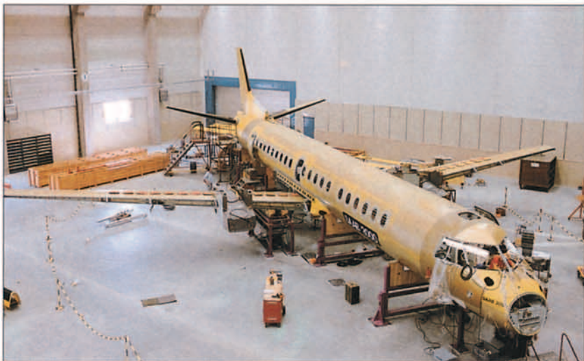
Fuselaje, ala y estabilizadores del primer SAAB 2000 debidamente ensamblados en la Factoría de Linköping (fotografía de N.G. Widh).
