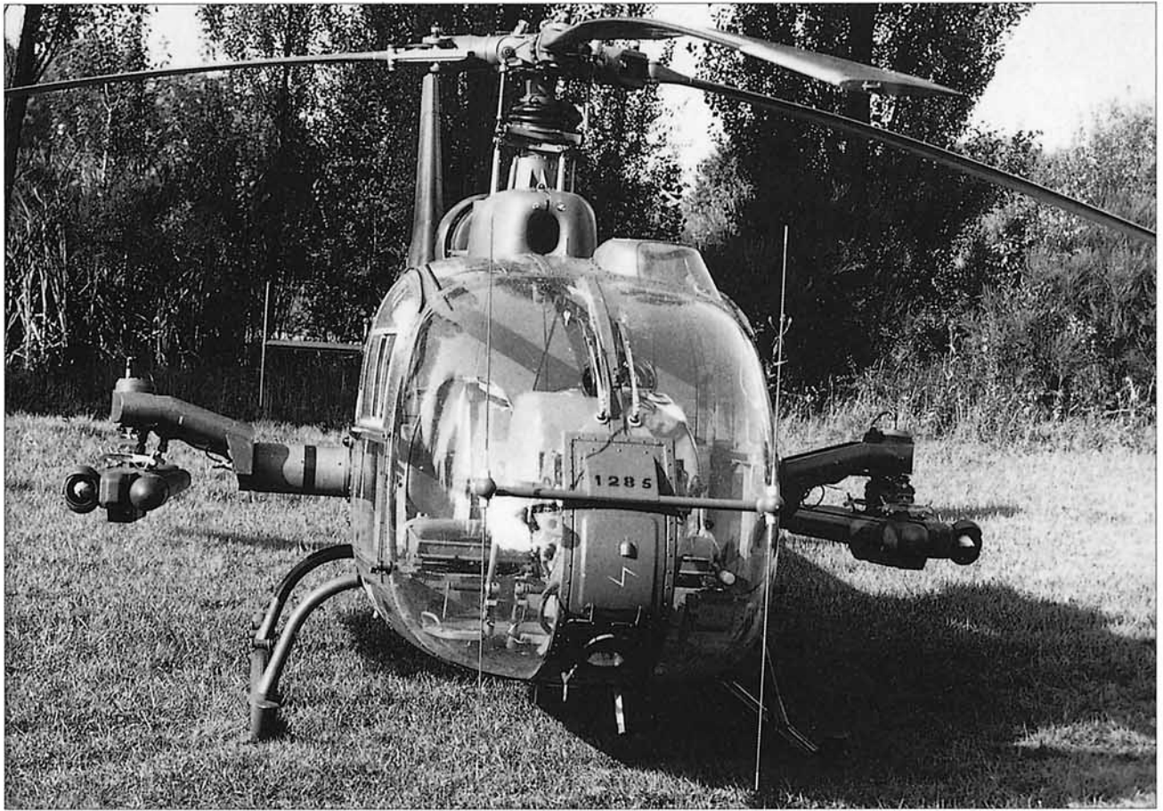
SA - 342 Gazelle, helicóptero francés de ataque al suelo, armado con misiles antitanque
