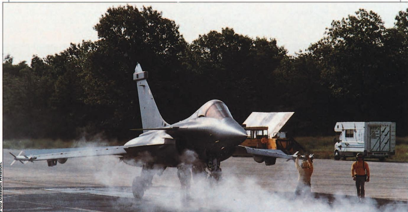
Fig. 8. Primer prototipo (MO1) de la versión naval del Rafale, de Marcel Dassault Aviation, que del 13 de julio al 23 de agosto de 1992, fue sometido en Estados Unidos, a pruebas de catapultado y frenado en el aterrizaje, en el Centro de Ingeniería Aeronaval de Lakehurst, en New Jersey, y en el Centro de Pruebas Aeronavales de Patuxent River, en Maryland.
