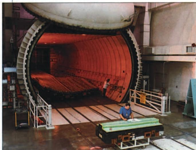
Fig. 1. El aumento de la utilización de materiales "composites" ha alcanzado en 1992 cotas muy elevadas. El Grupo de Defensa y Espacio de Boeing, ha montado en Seattle una autoclave para tratamientos por calor y presión, de piezas de "composites", que es la mayor del mundo: 27'43 m. de largo y 7'62 m. de ancho.
