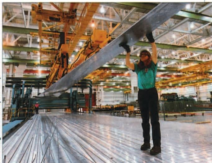
Fig. 2. Pieza de 82 metros de longitud, de material compuesto, cuyo proceso de fabricación hace Boeing en una nueva planta de producción exclusiva de "composites" que ha montado cerca de Tacoma y Seattle. La nueva factoría inició sus actividades en julio de 1992.
