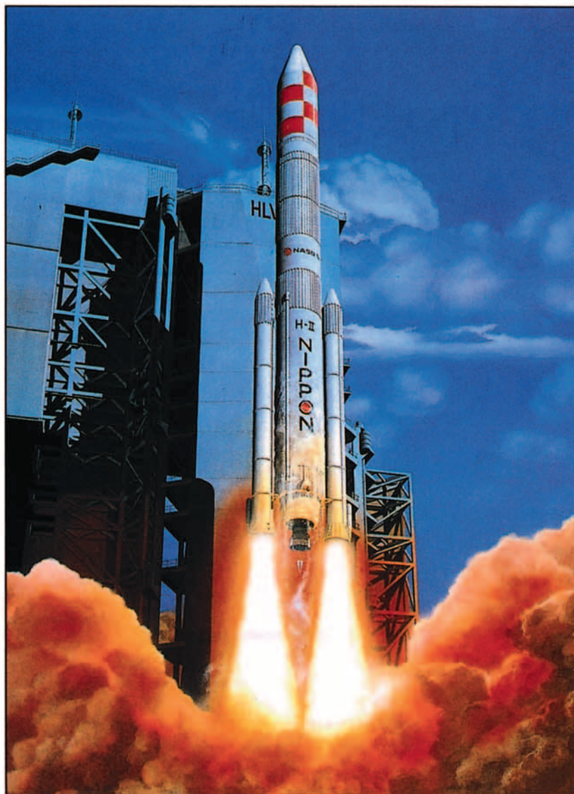
Fig. 13. Con el lanzador H-II, Japón podrá insertar en órbita geoestacionaria satélites hasta de 2 Tm; en órbita baja hasta 10 Tm. Podrá enviar sondas a Venus y Marte. Un primer vehículo experimental será lanzado en 1992. Está previsto que el H-II lance la nave HOPE.
