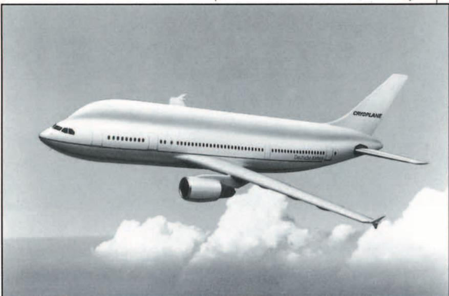
El "Cryoplane" de Airbus Industrie, estará propulsado por Hidrógeno Líquido (LH<sub>2</sub>) o Metano Líquido (LCH<sub>4</sub>). El proyecto es dirigido por Deutsche Airbus.
