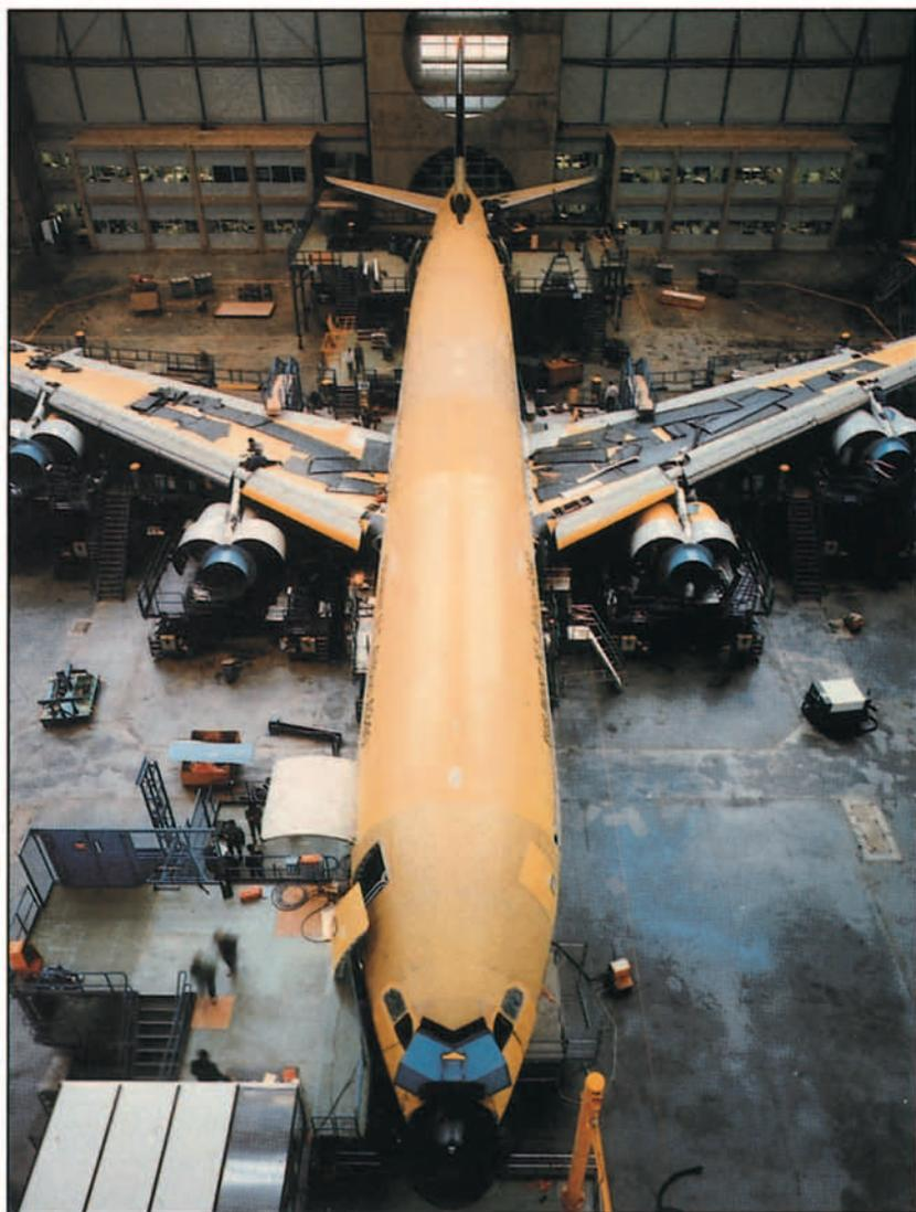
*A-340 de Airbus Industrie, en fase de montaje final en Toulouse. El 4 de octubre próximo realizará el "roll out". Propulsado por motores CFM 56-5C2, entrará en servicio con Lufthansa en 1993.*
