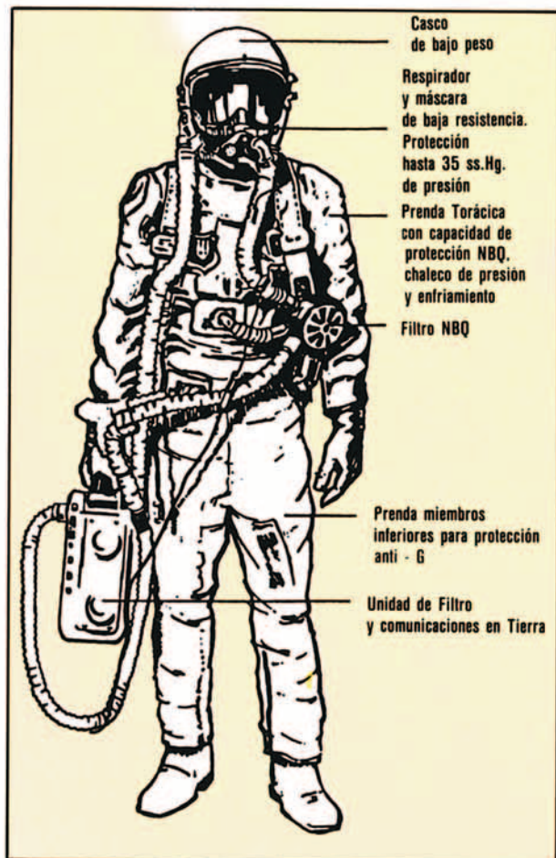
Fig. 3. Traje de vuelo completo que incluye sistema de protección NBQ diseñado para su próxima incorporación al Equipo Personal de las tripulaciones de la USAF.
