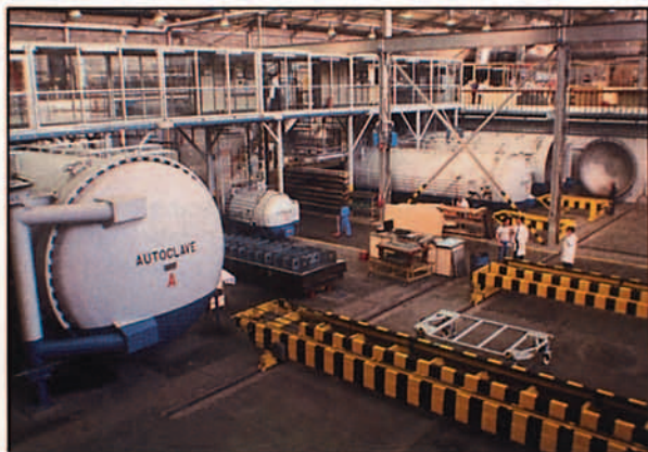
Nave de autoclaves del Departamento de Procesos Especiales de CASA.
