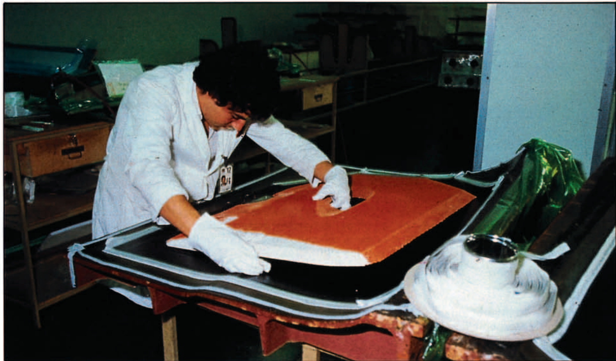
Montaje y preparación de un componente estructural para su posterior curado
