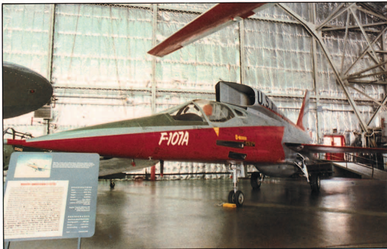
Un avión de extraña apariencia y poco conocido, el F-107. Desarrollado a partir del F-100, sólo se construyeron 3 prototipos.
