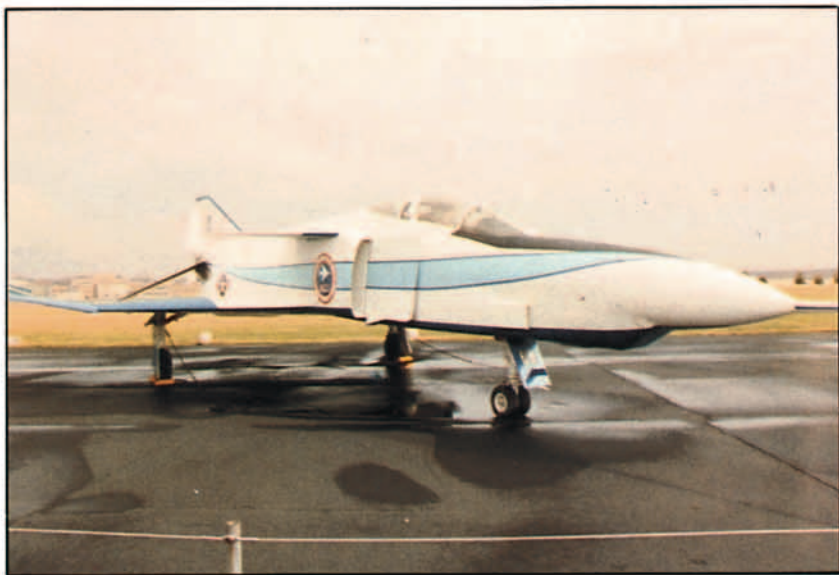
Un Phantom famoso. Empezó a construirse como un F-4B, pero acabó siendo el prototipo YRF-4C, luego YF-4E y finalmente se le instalaron unos "canards" y "fly by wire".
