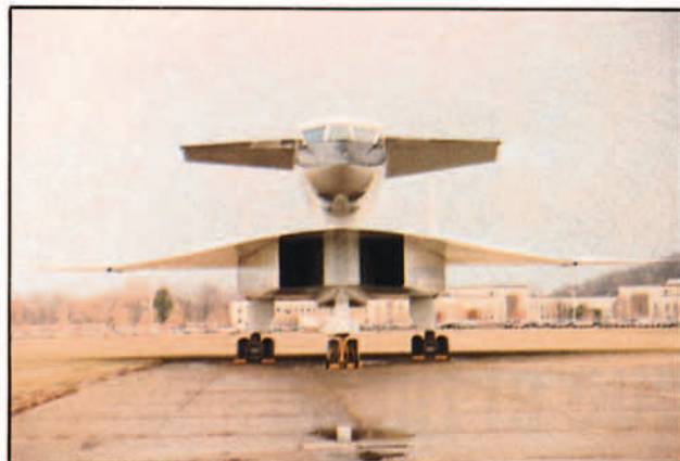
Una de las "estrellas" del museo: el XB 70 "Valkyrie", bombardero de 6 motores y Mach 3. Antes de que se cancelara el proyecto, la Unión Soviética desarrolló el Mig-25 para contrarrestarlo.
