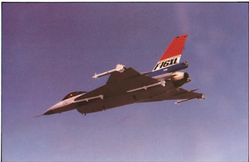
El F-16XL doble delta mejora sensiblemente el alcance del F-16 convencional. Compitió sin éxito con el F-15 mejorado, como caza de superioridad aérea.
