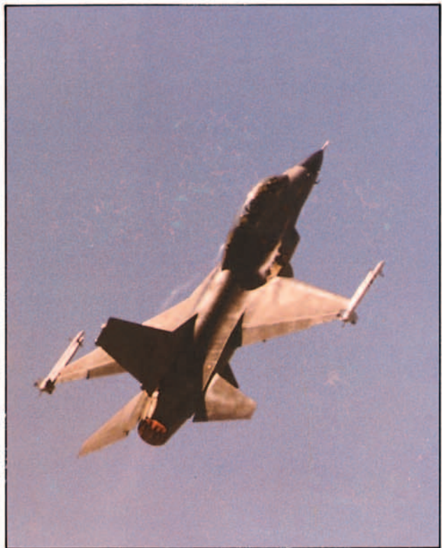
F-16/B en un fuerte tirón con postquemador. Pueden observarse perfectamente las estelas de condensación en los lérx producidas por la depresión en la unión plano-fuselaje.
