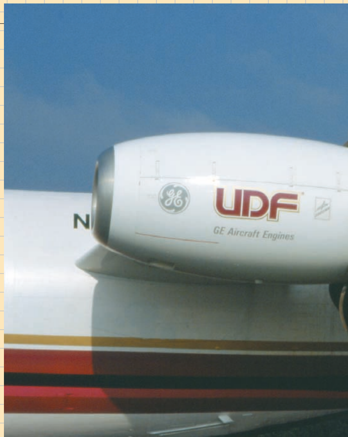
General Electric y McDonnell Douglas ensayaron sobre un MD-80 un prototipo GE.36, aeronave experimental que compareció en Farnborough 88. El concepto UDF fue abandonado no mucho más tarde. -J. A. Martínez Cabeza-
