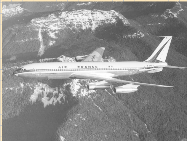
La llegada del turbofan JT3D, que equipó al Boeing 707-320B entre otros, permitió reducir notablemente el nivel de ruido y el consumo de combustible. -Air France, colec. J. A. Martínez Cabeza -
