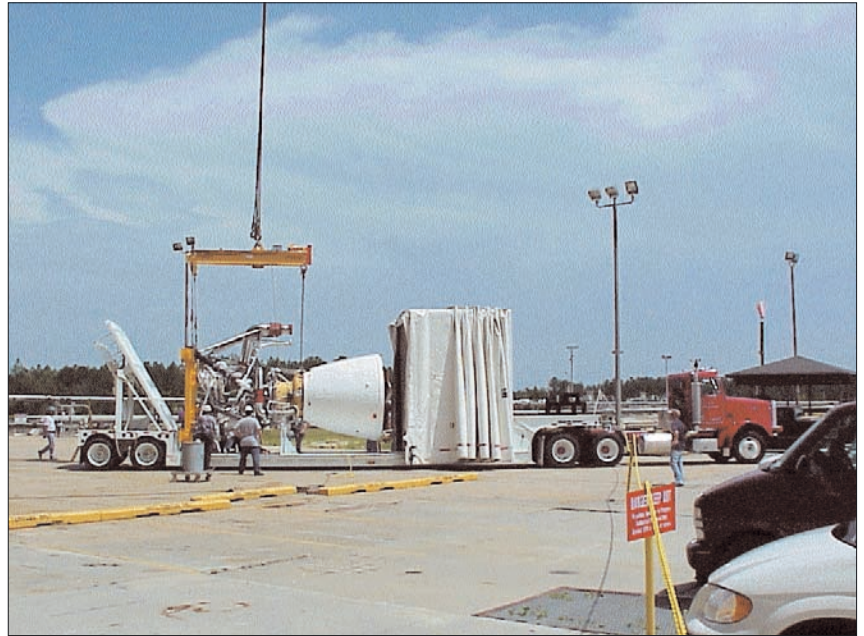
Llega un motor RS-68, preparado para ser unido a su CCB. (Foto: Boeing)
