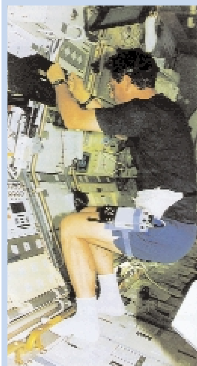
Astronauta trabajando en el laboratorio espacial de una lanzadera. Obsérvese como tiene sus pies libres en una abrazadera para evitar movimientos no controlados en condiciones de microgravedad.
