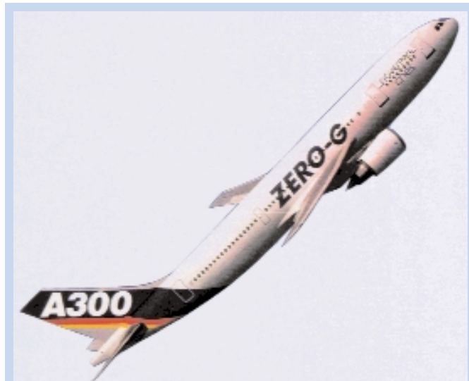
Avión Zero-G (gravedad cero), operado por Novespace de Francia, para ensayos de microgravedad en vuelos parabólicos por la Agencia Europea del Espacio (ESA).
