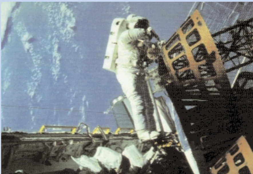
Astronauta haciendo una operación de taladrado durante la misión STS-51 D. El esfuerzo que realiza es pequeño pues la herramienta prácticamente no pesa en condiciones de microgravedad.
