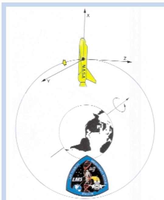
La lanzadera Discovery en la misión STS-78, realizó desplazamientos en la espectacular posición ZLV (Zero Lift Velocity.- Velocidad con sustentación cero), para medir las diferentes vibraciones en la dirección de los ejes de referencia de la lanzadera.
