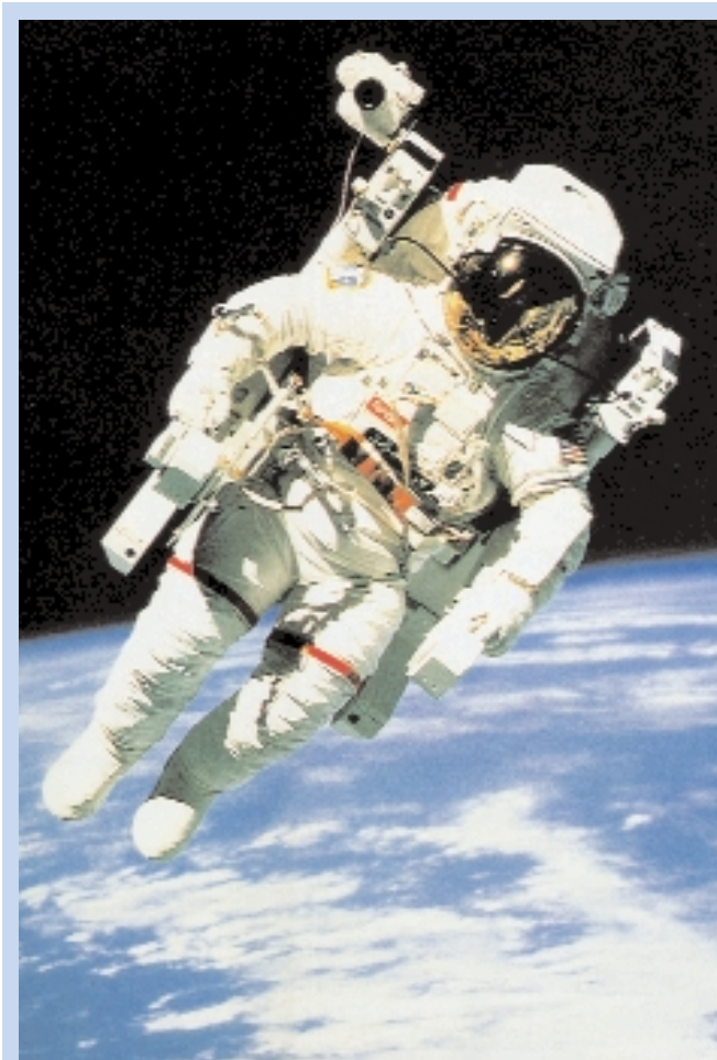
Astronauta en una misión extravehicular; la unidad de control manual (véase texto), le permite moverse a su voluntad, pudiendo alejarse unos 100 metros del transbordador.
