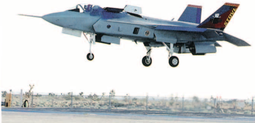
El primer vuelo del X-35B efectuado el 23 de junio de 2001 no fue de carácter convencional, cual fue el caso del X-32B: se trató de un corto vuelo vertical de subida y posterior descenso. Lockheed Martin
