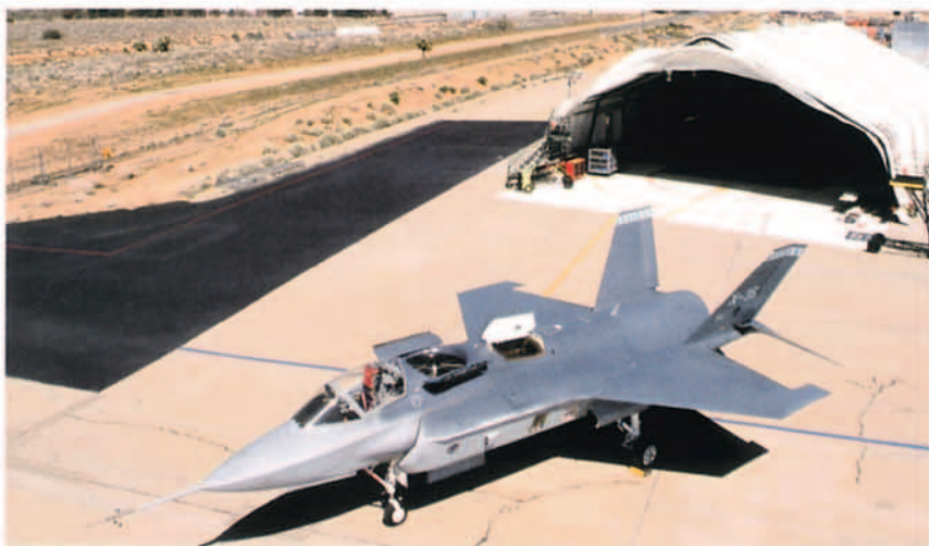
Un vista superior del X-35B que le muestra con las puertas del «Lift Fan» y de la toma auxiliar de aire para el motor F.119-SE611 abiertas. La tobera del motor está en posición de vuelo vertical, pero la perspectiva no permite observarla. Lockheed Martin
