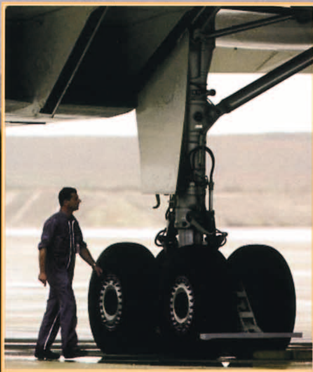
La pata derecha del tren principal del Concorde de Air France F-BVFB equipada con los neumáticos Michelin NZG. Se aprecia el deflector de agua que en su momento fue considerado causante de la rotura del depósito del F-BTSC.
