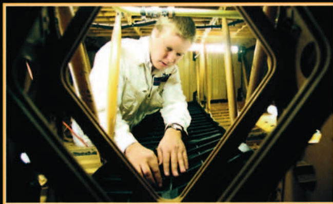
Instalación de una de las piezas de la protección interior de caucho sintético y kevlar en los depósitos de combustible del Concorde G-BOAF de British Airways.
