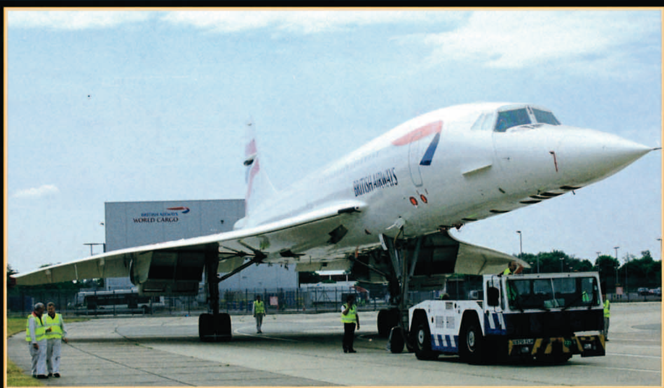
El 19 de junio salió de los hangares de British Airways de Hatton Cross el Concorde G-BOAF con sus depósitos de combustible y sus cableados eléctricos en zona de tren debidamente modificados.
