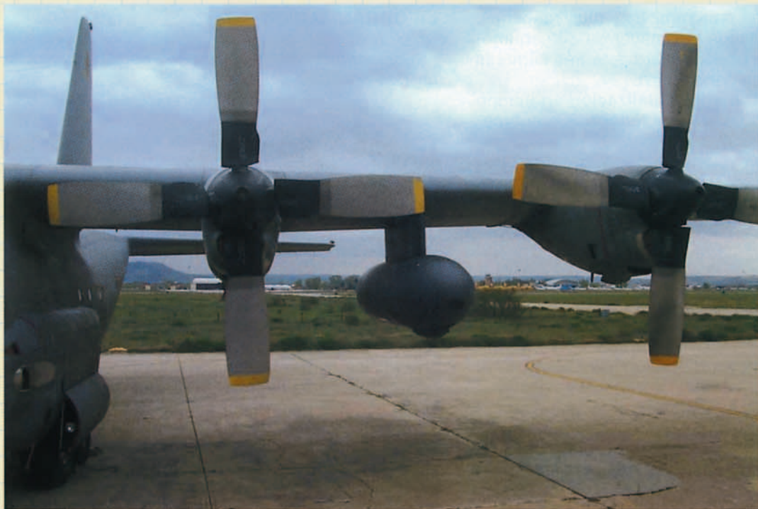
El depósito (POD) contiene los sensores establecidos por el Tratado y es usado en común por un mismo grupo de países (Grupo del POD).
