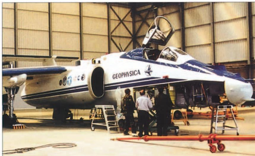
interno para el alojamiento de equipos muy diversos (de naturaleza militar al principio y científica en la actualidad). El resultado es un avión capaz de volar a gran altitud (21 Km) con una velocidad de vuelo (700 Km/h) y una autonomía (6,5 horas) aceptables.
