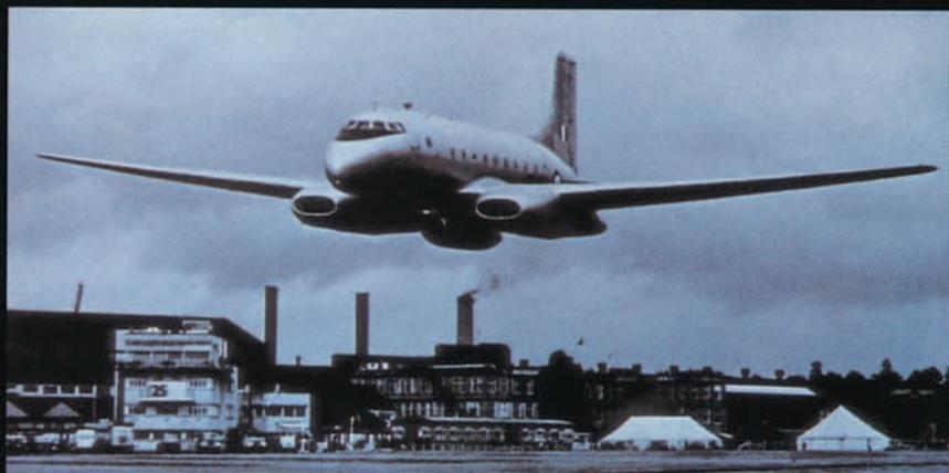
*El Ashton Mark 2 en vuelo a baja cota en las instalaciones del RAE de Farnborough. Nótese la góndola para ensayos de motor situada bajo el fuselaje.*
