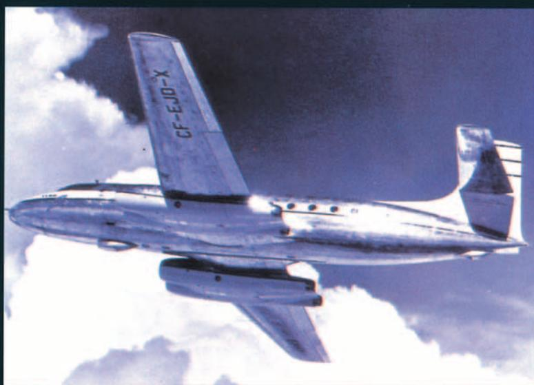
*El Avro Canada C.102 fue víctima de la falta de un motor adecuado y de una excesiva resistencia aerodinámica.*
