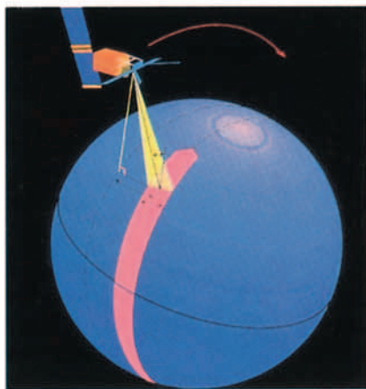
Figura 9. Satélite heliosincrónico ERS (European Remote Sensing Satellite), para observación de la Tierra. Se han lanzado dos satélites de este tipo; el ERS-1 el 17 de julio de 1991, y el ERS-2 lanzado el 21 de abril de 1995. A la derecha de la figura, la traza de observación en sentido ascendente.
